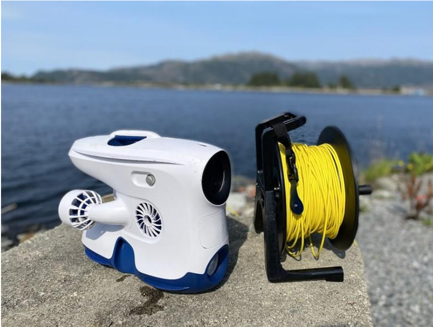
Figur 3-4: ROV (Blueye Pioneer), Ipad og konsoll ble brukt til kartlegging av sjøbunn.
