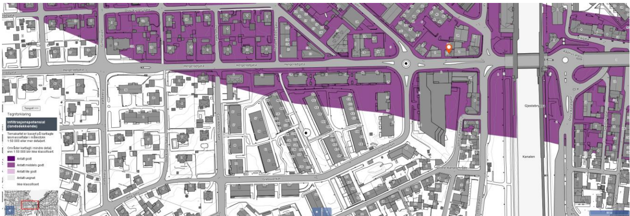
Figur 6: Infiltrasjonsevne i planområdet (Løsmasser (ngu.no))
