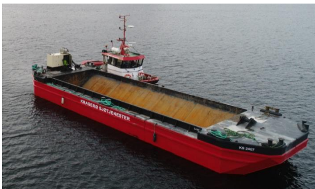
Splittlekter – i forbindelse med bygging av fylling i kanalen
