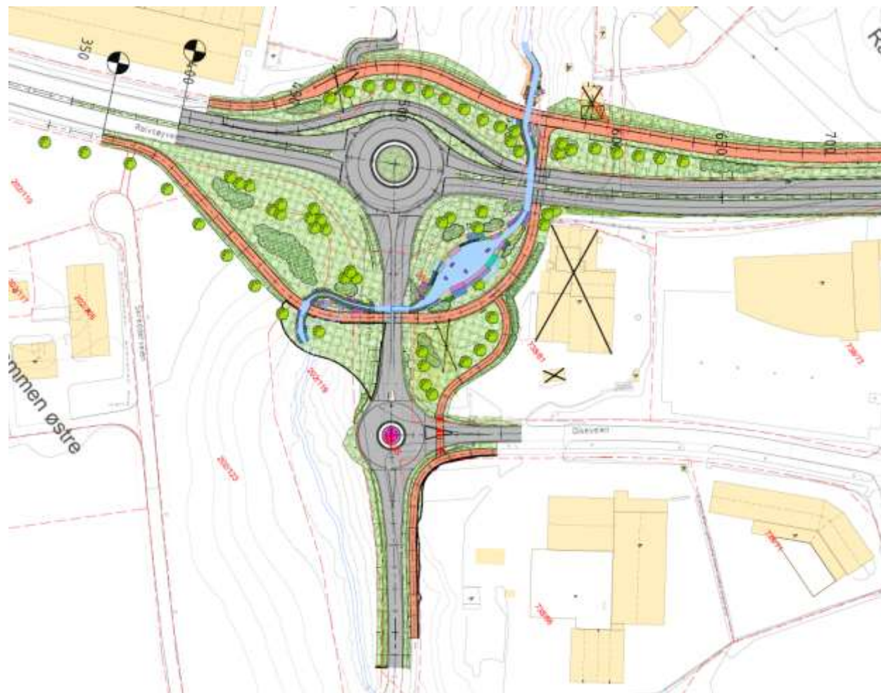
Figur 6-1: O-tegning for krysset Evjebekkveien x fv. 109 og Evjebekkveien x Dikeveien. Nord mot høyre
