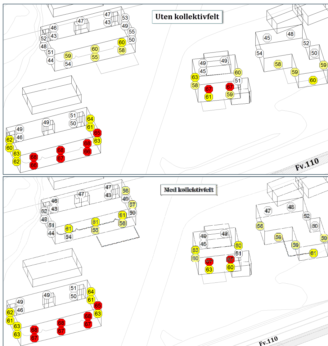
Figur 4: Punktberegninger L_{den} på fasade, uten og med kolektivfelt. Adressene Haugstenveien 2, 7 og 9, og Lillebyveien 2. Fargene på punktene gjenspeiler gul og rød støysone iht. T-1442/2016.
