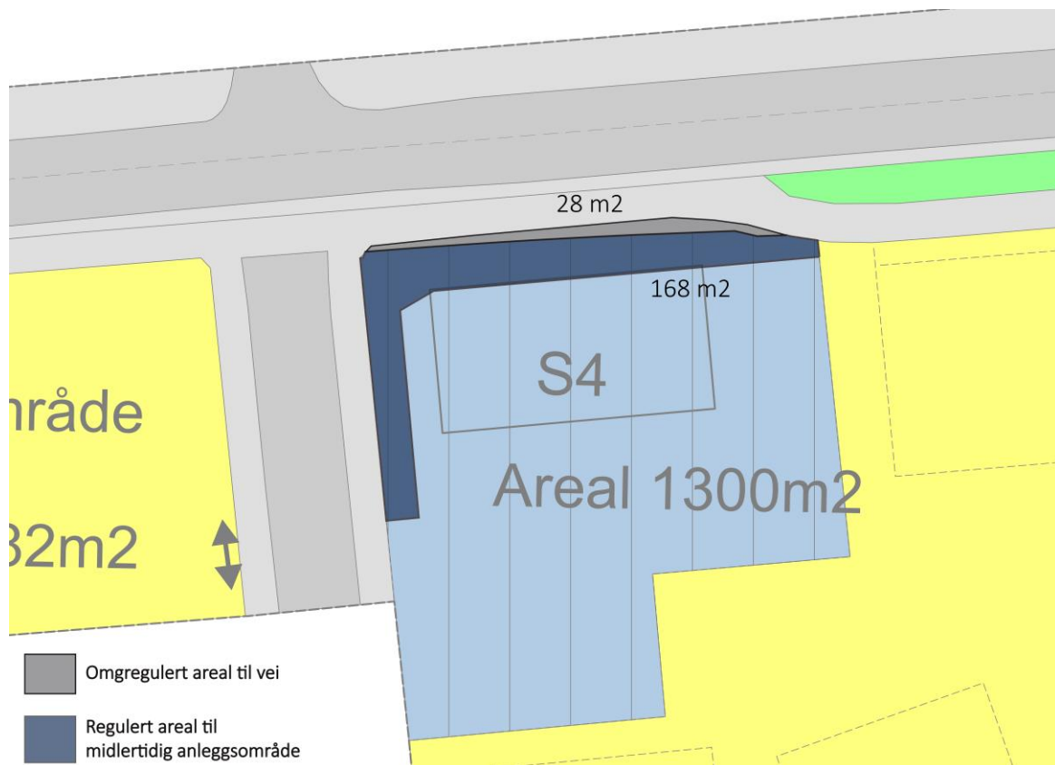
Figur 64 Illustrasjonen viser omreguleringen av arealer for den tidligere administrasjonsbygningen til Moss Glassverk i Cort Adlers gate 8. Det grå arealet på 28 m 2 reguleres til fortau i planforslaget og 168 m 2 av forhagen reguleres til midlertidig bygge- og anleggsområde, men som skal istandsettes etter anleggsperioden.
