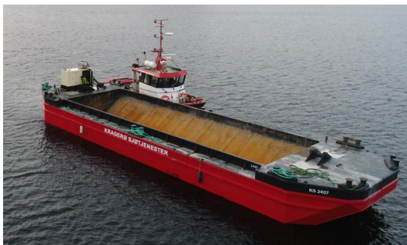
Figur 2-3 – Eksempel på splittlekter. Denne kan ta opp mot 150 lm 3 og er 24 m lang og 7m bred
