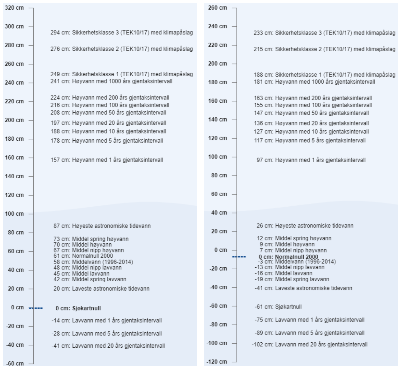
Figur 1-4 – Vannstander fra Sehavnivå.no i forhold til Sjøkartnull (til venstre) og i forhold til NN2000 (vår høydereferanse på tegninger og i modell) (til høyre)
