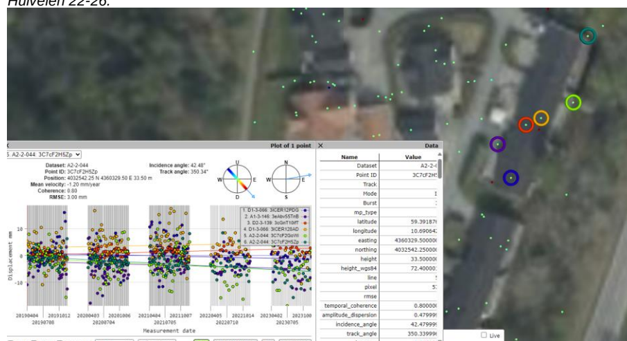
Figur 4-11: Punkter registrert med minst nedadgående eller økende trend på setninger registrert i INSAR, ref. [1], på Hulveien 22-26.
