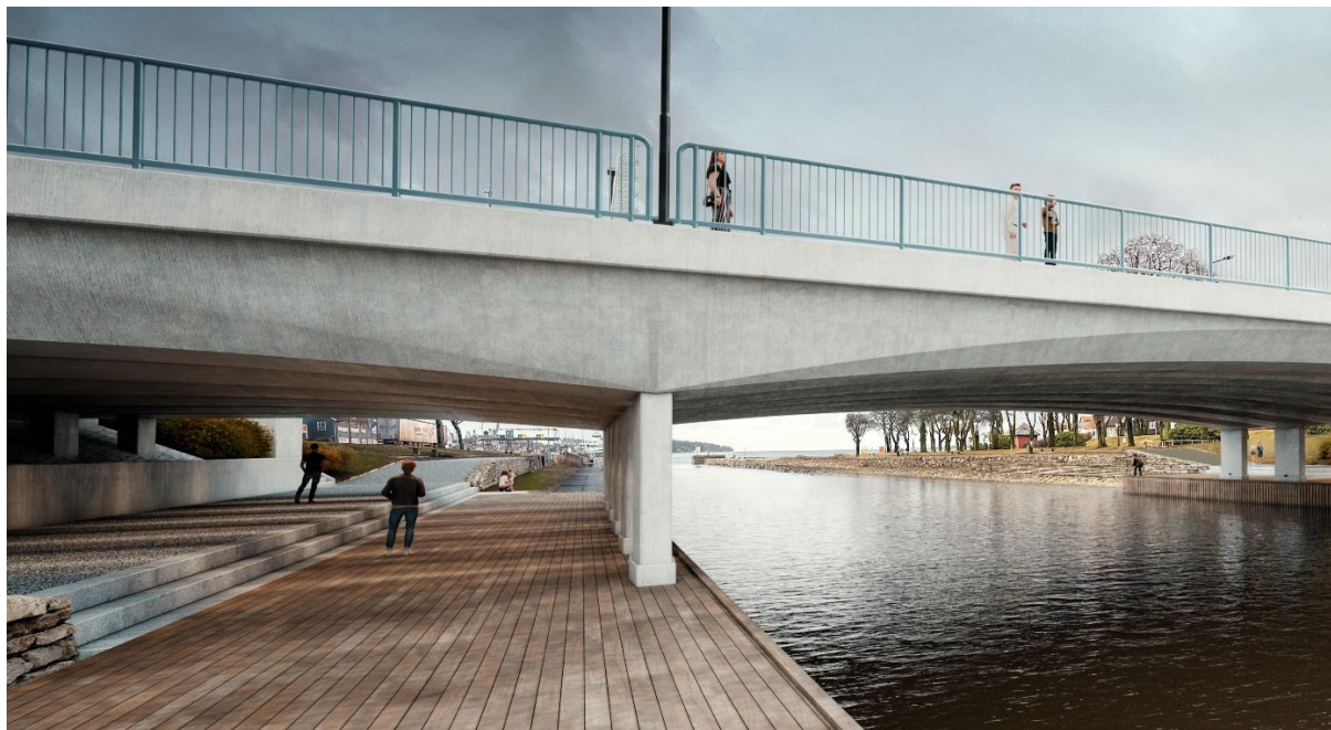
Figur 13-4 Trebrygge og grussti langs østsiden av kanalen. Støpt støttemur innenfor grussti, og steinplastring i skråningen opp til landkaret.
