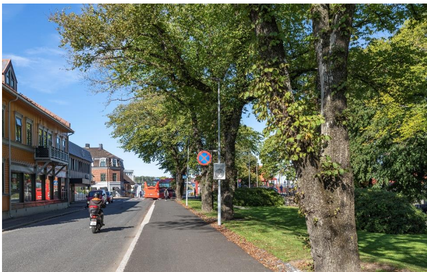
Figur 12-4 I midlertidig veianlegg vil gangvei anlegges mellom de to trærne midt i bildet, ved forbudsskiltet. Trærne ønskes bevart, og nødvendige tiltak må iverksettes for å beskytte rotsone og stammer/ krone. De to nordligste trærne, ved bussen, må fjernes. Jfr. også planutsnittet under; figur 12-5.
