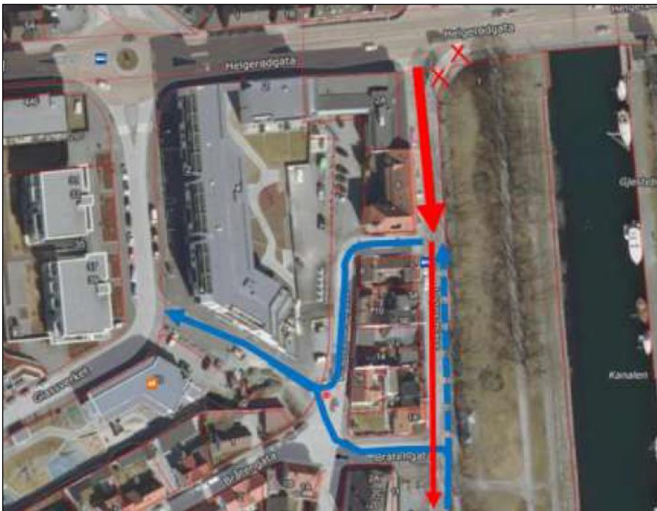
Figur 17 – Skisse av enveisregulert Logns plass med ny kjøretrasé til Glassverket (Fylkeskommunen sitt innspill til vurdering).
