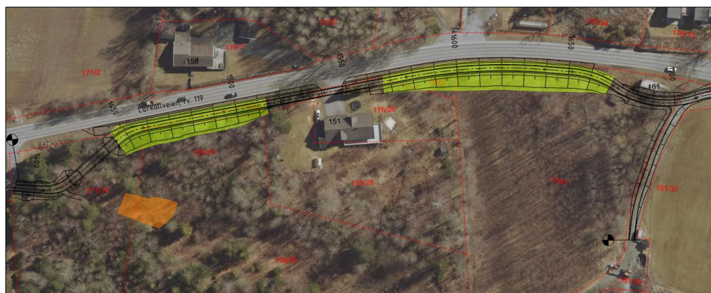
Figur 26 Utklipp fra områdestabilitetsutredning, vedlegg 20 (stor tegning V202 finnes i vedlegg 10 «Teknisk plan»): Grønn farge viser ca. omfang lette masser i fylling for GS-veg.
