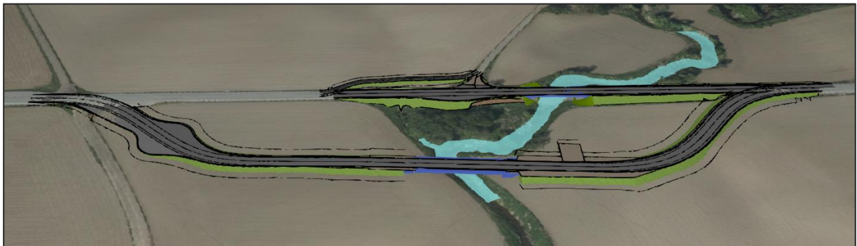
Figur 2-2 Oversikt over ny bru med tilhørende tilpasninger og midlertidige veier og bru.
