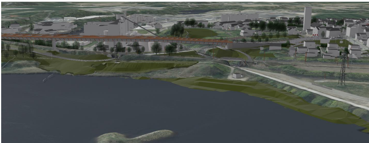
Figur 3-11: Modellbilde som viser støttefyllinger i og langs Glomma på Tarris sett fra nord. GIS-modell Multiconsult.
