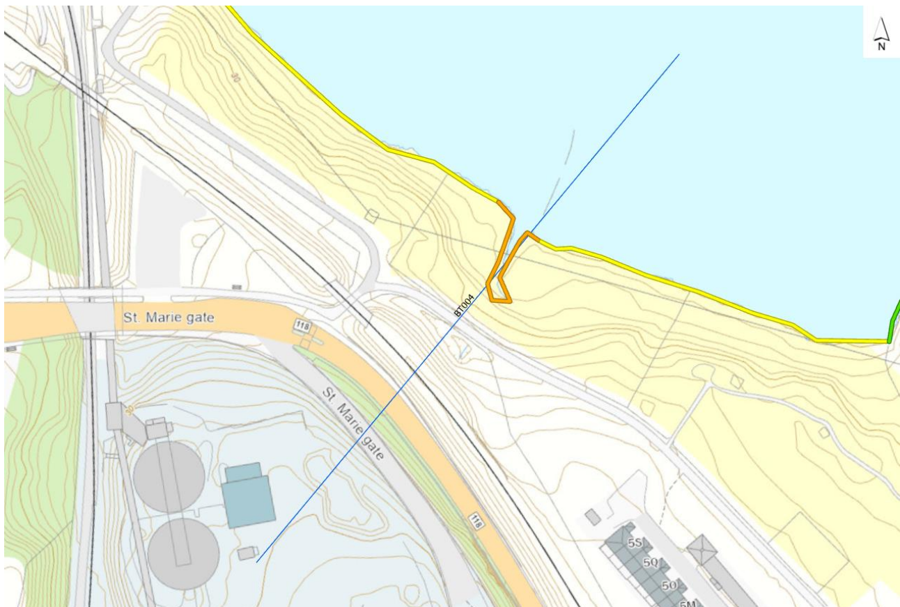
Figur 5-20: Plassering av kritisk snitt BT004. Gul og oransje linje viser vurdert erosjon, henholdsvis «litt» og «noe» erosjon.
