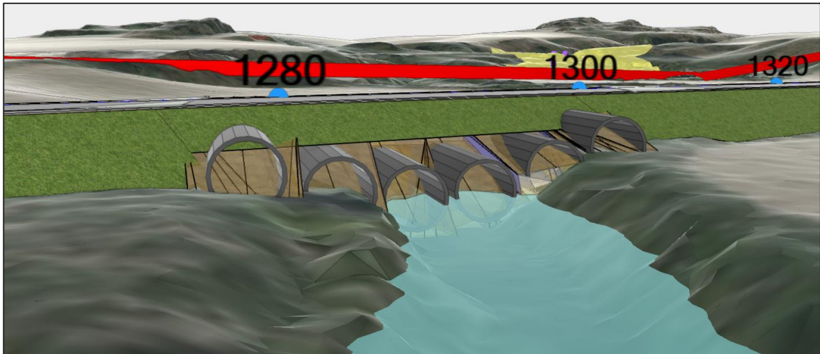
Figur 3-7 Rørløsning, rør med diameter 2400 mm, med tilsvarende høyde på veillinjen som i dag (alternativ 5b-1 / 5b-2)
