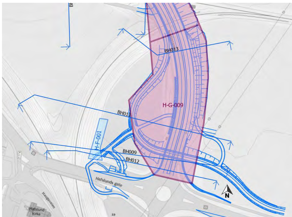
Figur 13-1: Snitt BH009, BH011, BH012 og BH013. Planlagt tiltak er markert med blå linjer/polygoner. H-F-001 er avlastingsiltak og H-G-009 er planlagt veifylling i EPS.
