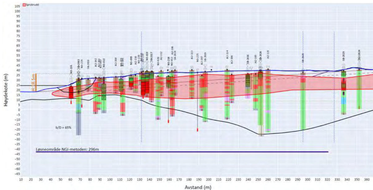
Figur 5-13: Utklipp av snitt H004, brukt til å bestemme løsneområdet. Det røde polygonet representerer løsmasser som kan ha sprøbruddegenskaper. Utklippet er tatt fra Multiconsult sitt egenutviklede profilopptegningsverktøy.
