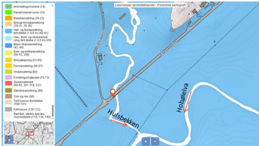
Figur 4: Topografi og kvartærgeologi løsmassekart som viser at løsmassene i området består av tykke marine avsetninger (NGU- løsmassekart)
